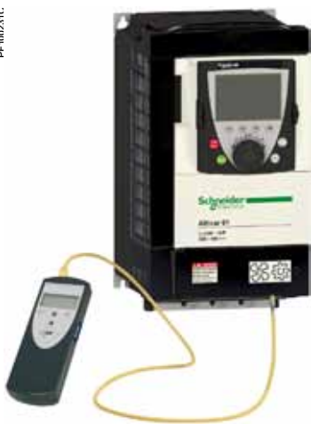
Multi-Loader多功能下载器连接至ATV61变频器的配置
